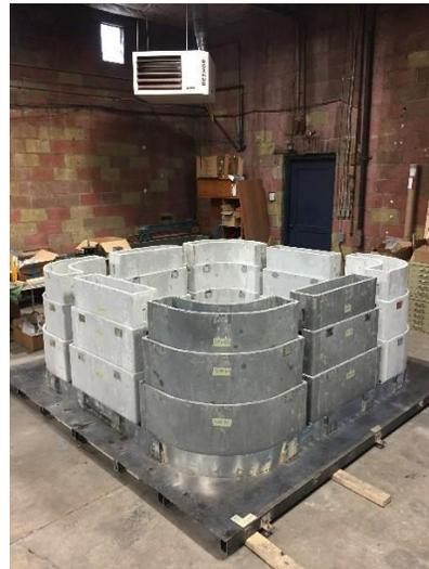
Prototipos a escala reducida de Smart Walls telescópicos de UHPC para edificios (izquierda, retraído; derecha, extendido)
