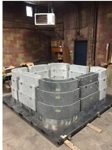
用于建筑物的超高性能混凝土伸缩式智能墙按比例缩小原型（左，收缩；右，伸展）
